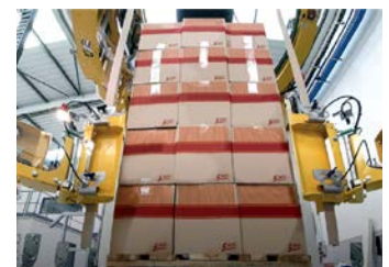
Aplicación Automática De Tableros De Esquina
