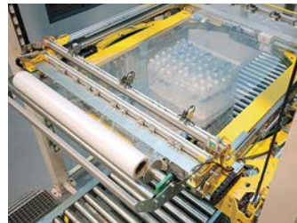
Dispensador De Láminas Superiores A Prueba De Polvo Y Lluvia
