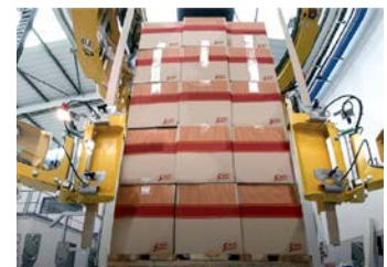
Aplicación Automática De Tableros De Esquina
