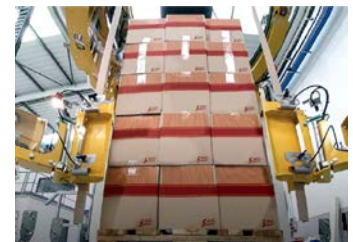
Aplicación Automática De Tableros De Esquina
