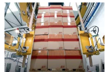
Aplicación Automática De Tableros De Esquina
