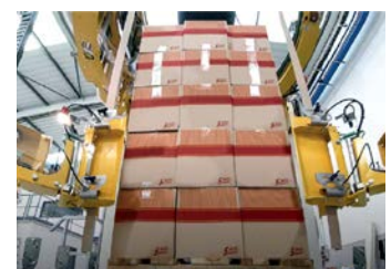
Aplicación Automática De Tableros De Esquina
