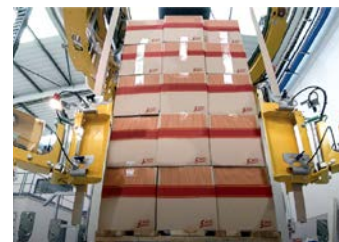
Aplicación Automática De Tableros De Esquina
