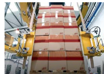
Aplicación Automática De Tableros De Esquina
